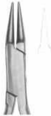
2699 Fig. 28 14 cm, 5 1/2" Sling clasp & wire bending plier.
